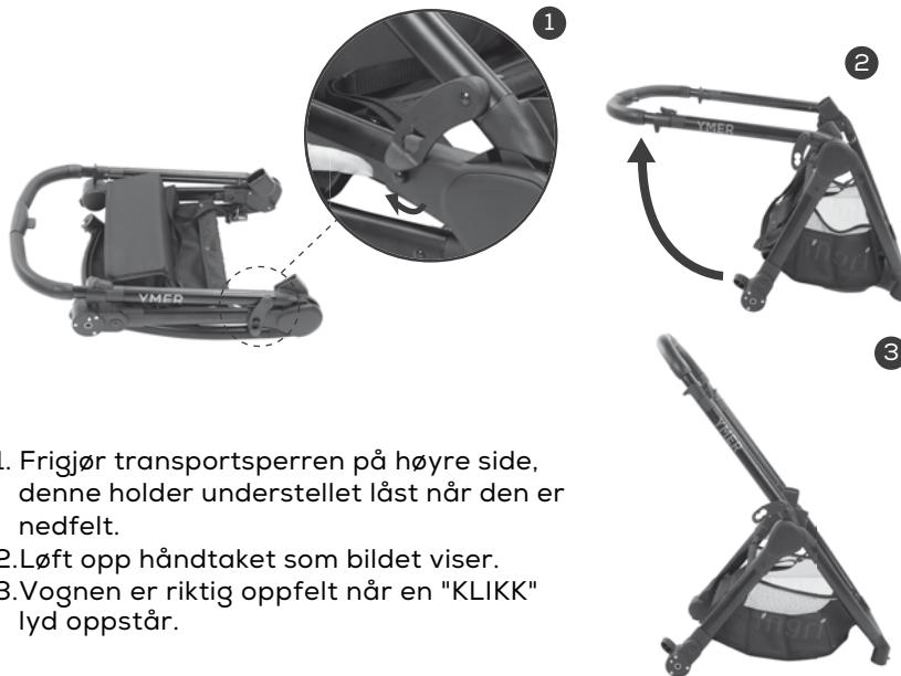
1. Frigjør transportsperren på høyre side, denne holder understellet låst når den er nedfelt.
