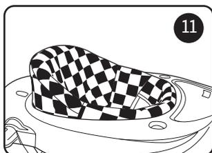
Sätt först in stiften i framsidan av sätet i hålen på det övre brickan med hänvisning till fig 9.
