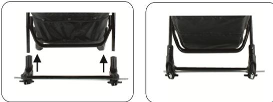
För montering av bakhjulsaxeln, tryck bakaxeln på höger och vänster sida av chassit. Pressa ända tills bakaxeln hamnar i låst läge.
